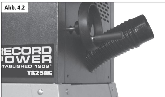
2. Bringen Sie den Absaugstutzen am Ende des Schlauchs an und klemmen Sie ihn fest. **Abb. 4.3.**
